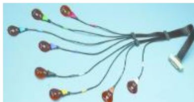
Рисунок 3. Восемь датчиков приема радиосигнала от видеокапсулы
