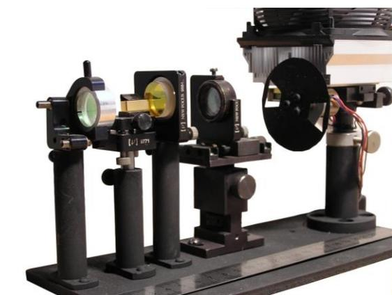
Рисунок 1 – Первичный образец малогабаритного лазерного излучателя
